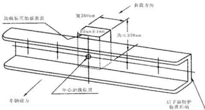
图 A2 加载装置示意图
